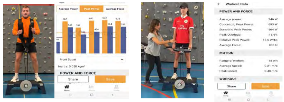
Figura 3. Uso de la plataforma isoinercial Kbox4 Lite y App incorporada Kmeter2
